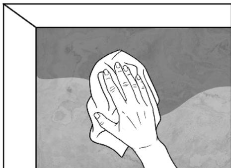
Humidifier un chiffon sec avec l'hydrofuge Akemi et protéger uniformément la pierre. L'hydrofuge retirera le surplus de colle par la même occasion (dans les 10 minutes après la pose). 20 minutes après : enlever l'excédent avec un chiffon propre.
